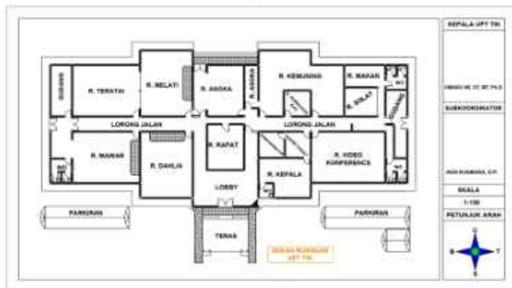
Gambar 2 : Denah Gedung UPT TIK
