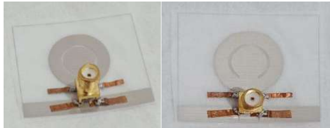
Gambar 5: Tampilan Antena Fabrikasi tampak samping dan depan
